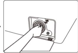
3: قم بتثبيت غطاء المضخة وأحكام ربطه للتأكد من عدم وجود سرب للمياه من مضخة التصريف، كما هو موضح في الشكل. قم بتثبيت الغطاء الواقى لمضخة التصريف!
